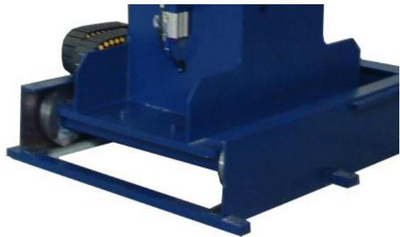
**TRASLAZIONE** dell'aspo per agevolare l'allineamento del coil con la macchina successiva, lo spostamento è ottenuto con sistema idraulico comandato da un selettore.
