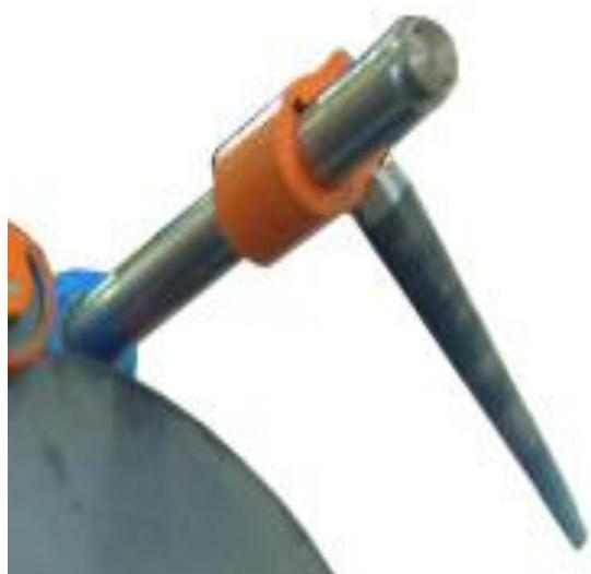
**N. 2 CONI DI CONTENIMENTO LATERALE DEL COIL,** sostituendo le baionette, riducono i tempi di cambio del coil e permettono di poter utilizzare bracci larghi anche con coil stretti. La traslazione per adeguarsi alle diverse larghezze del coil e la rotazione degli stessi è motorizzata e comandata dal pulpito principale.
